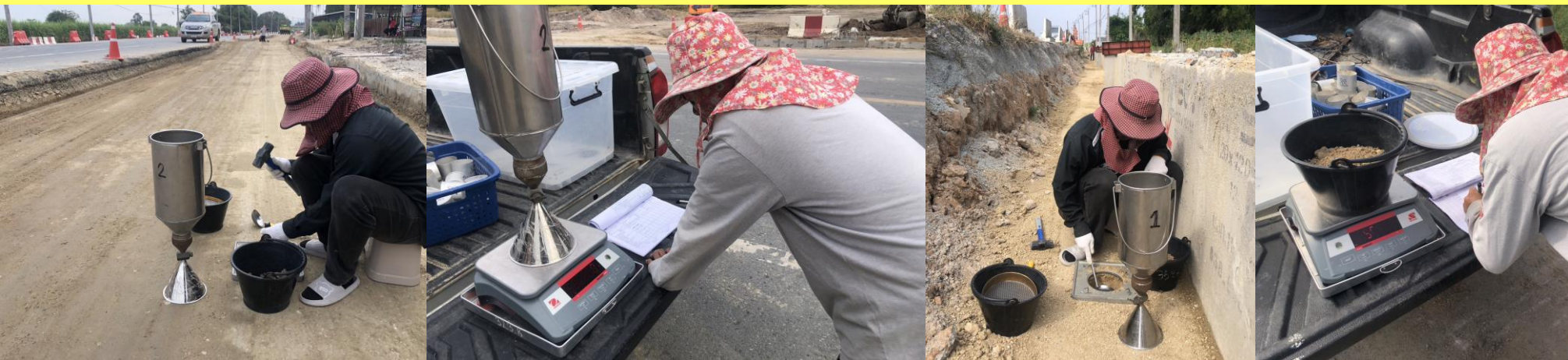
งานทดสอบความแน่นในสนาม ชั้นดินถมคันทาง
